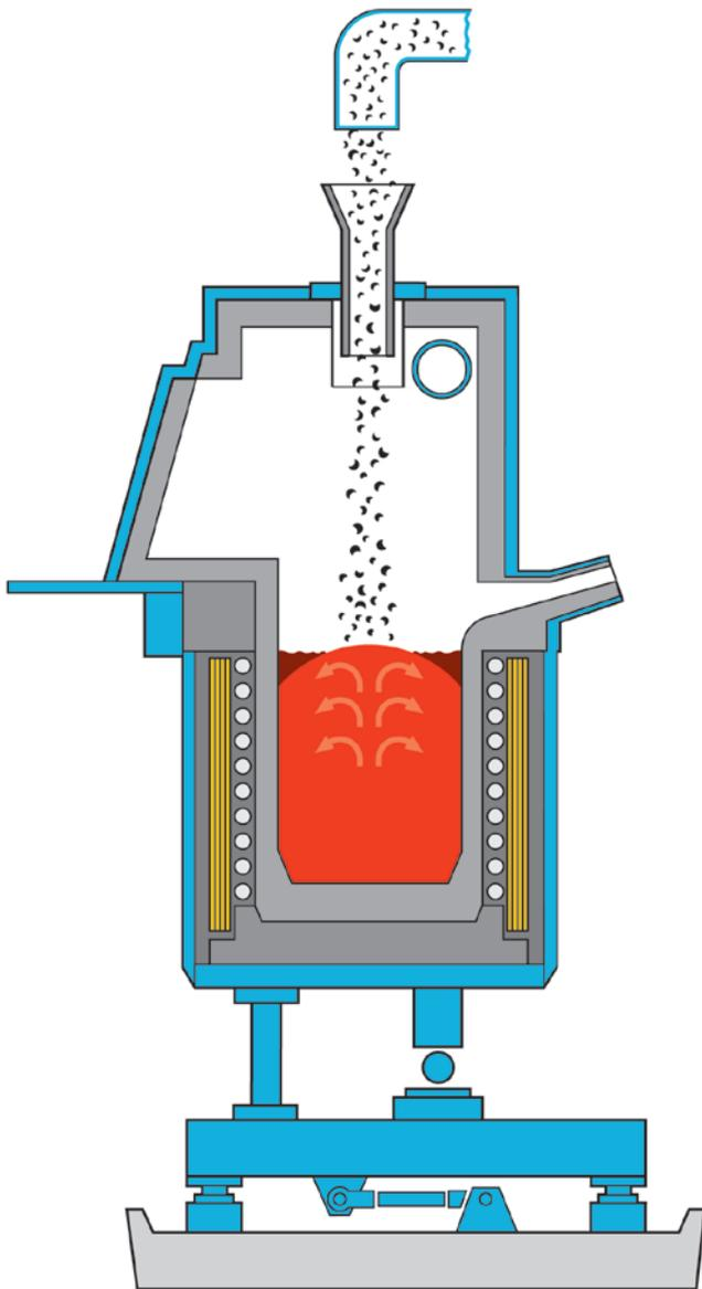
Der INDUGA-Tiegelofen-Prozess zum Einschmelzen von Spänen ist durch eine feuerverfestigte Haube charakterisiert, die zentrisch ein Fütterrohr zur Aufgabe der Späne direkt auf die Schmelze besitzt.
