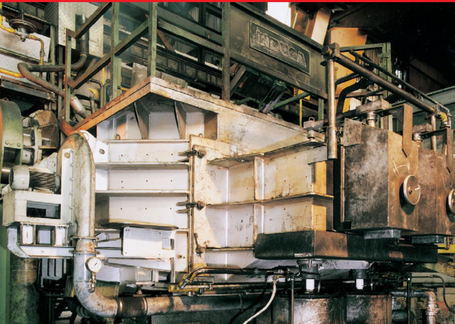
Die Anforderungen an die Qualität der Schmelze bei der Herstellung von Halbzeug im Strangguss steigen ständig. Um die maximale Auslastung der Stranggießanlagen zu gewährleisten, muss gießbares Metall in ausreichender Menge und mit konstanter Gießtemperatur zur Verfügung gestellt werden. INDUGA hat für diese Anforderungen den induktiv beheizten Gießofen mit Vorherd optimiert. Er dient als Puffergefäß zwischen Schmelzen und Gießen.
